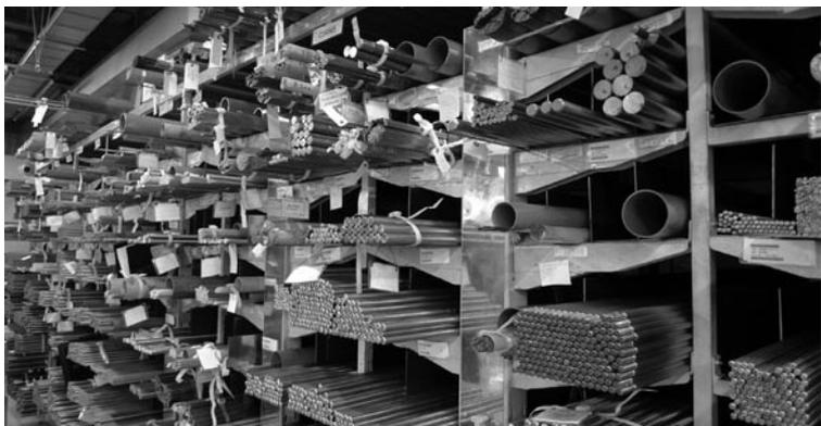
工場内でいつでも使えるように保管されているアルミ、チタン、ステンレス、真ちゅうの金属棒。使用する部品に要求される最適な物性を選んで、すぐに作り出せる体制が整っている。ネジ一本から部品の精度にこだわるナカニシらしい光景。
